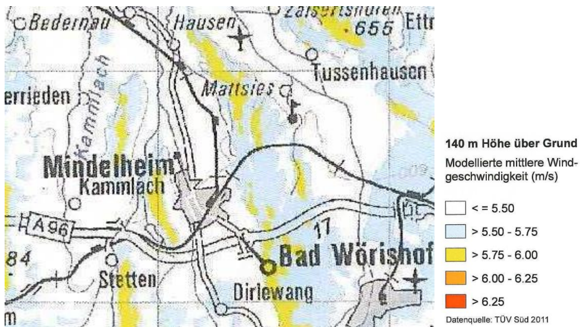
Abb. 32: Modellierte mittlere Windgeschwindigkeit in m/s auf 140 m Höhe über Grund im Stadtgebiet Mindelheim (Windatlas des TÜV Süd für die Region Donau-Iller)
